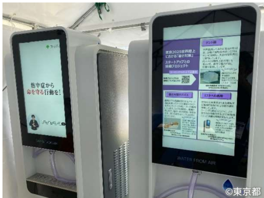
【空気中の水蒸気から水を精製する製水機】
