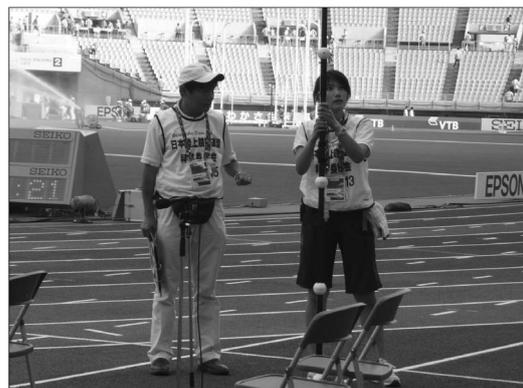
写真3. 100mの3次元動作分析のためのキャリブレーション風景
