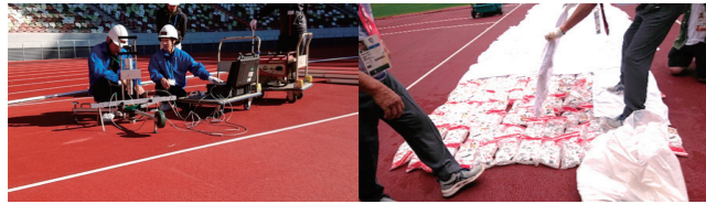
写真10 衝撃吸収、垂直変位検査
